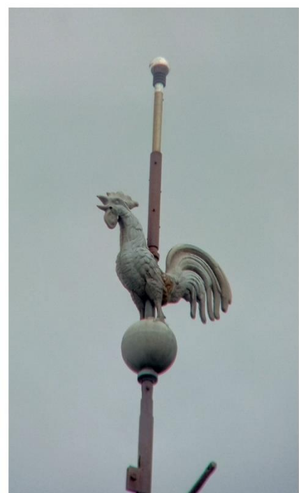
Le coq avec les 20x80 VIXEN. On note les défauts de l'optique Chromatisme et flou en bord de champ.
