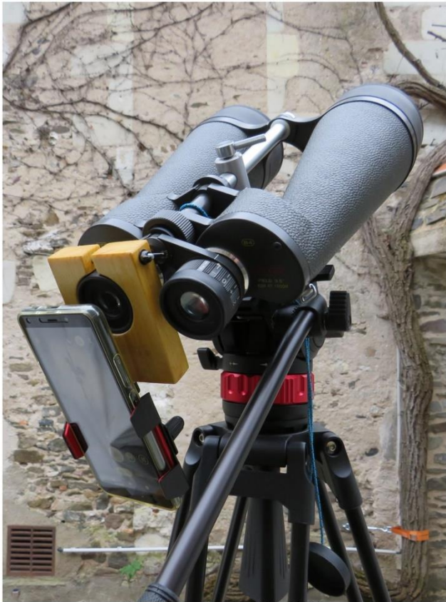
Montage derrière mes VIXEN 20x80 Là, adaptation nécessaire, le diamètre de l'oculaire est trop grand pour le montage standard.
