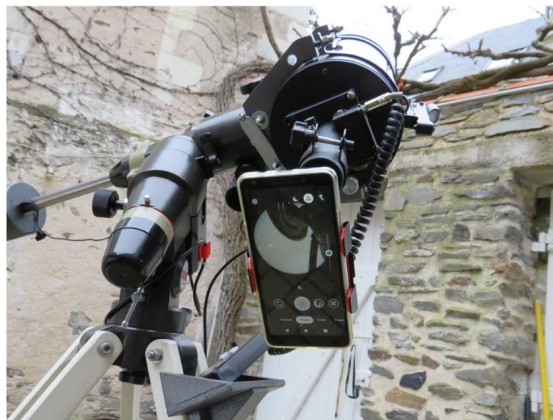
Montage normal derrière l'ETX 127. Pointage sur le coq du clocher de Denée, mon repère préféré !
