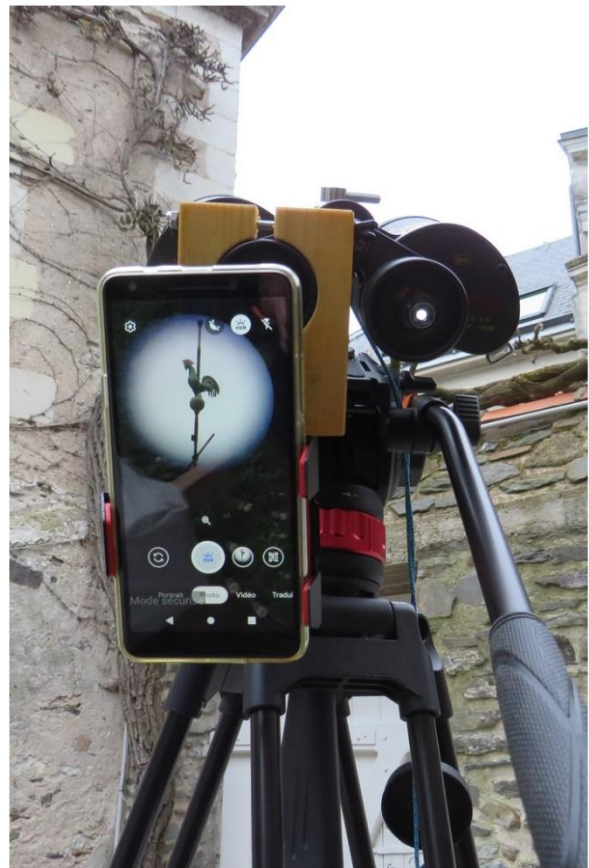
Montage derrière mes VIXEN 20x80 Là, adaptation nécessaire, le diamètre de l'oculaire est trop grand pour le montage standard.
